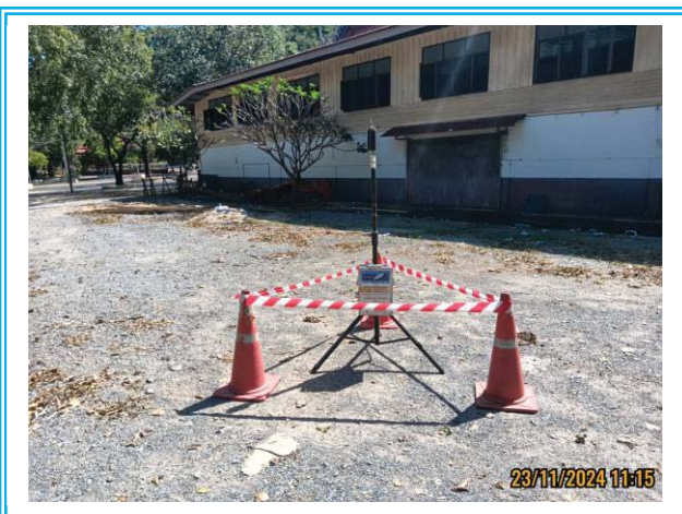
รูปที่ 4.3-14 แสดงการตรวจวัดระดับเสียง บริเวณบ้านเขากำแพง (วัดเขากำแพง) ตรวจวัดระหว่างวันที่ 22-25 พฤศจิกายน 2567
