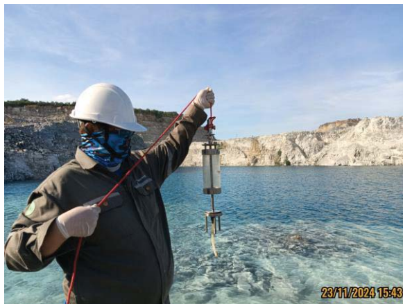
รูปที่ 4.3-22 แสดงการเก็บตัวอย่างเพื่อตรวจวัดคุณภาพน้ำผิวดิน น้ำในชุมชนเมืองของโครงการ วันที่ 23 พฤศจิกายน 2567
