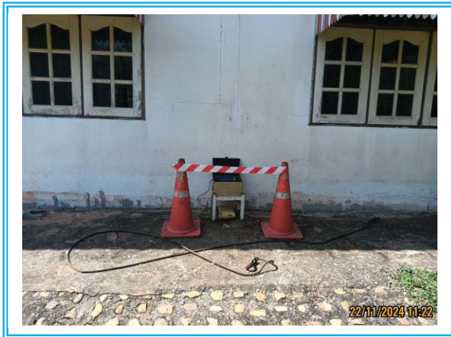
รูปที่ 4.3-17 แสดงการตรวจวัดความสั่นสะเทือน บริเวณบ้านเลขที่ 63 บ้านพวน ตรวจวัดในวันที่ 22 พฤศจิกายน 2567
