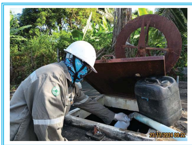
รูปที่ 4.3-33 แสดงการเก็บตัวอย่างเพื่อตรวจวัดคุณภาพน้ำใต้ดิน บริเวณบ่อบาดาลบ้านพวน เก็บตัวอย่างวันที่ 23 พฤศจิกายน 2567
